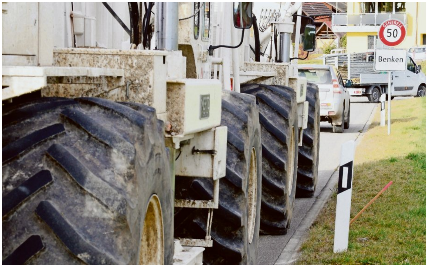
Riesige Vibrationsfahrzeuge der Nagra führten vor gut zwei Jahren seismische Messungen im Zürcher Weinland durch.
